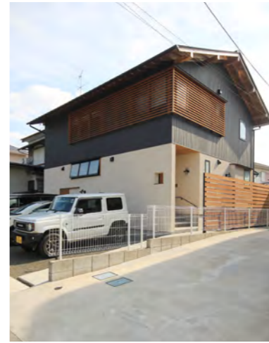
外観 北道路からの外観。ガルバリウム鋼板と左官壁のツートンスタイル。2階の窓に横格子を設置し、目隠しと意匠を兼ねている。
