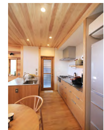
コロボオリジナルの二の字型キッチン。床はダイニングと同じ栗材を張り、タモの木を使ってキッチンがつけられている。
