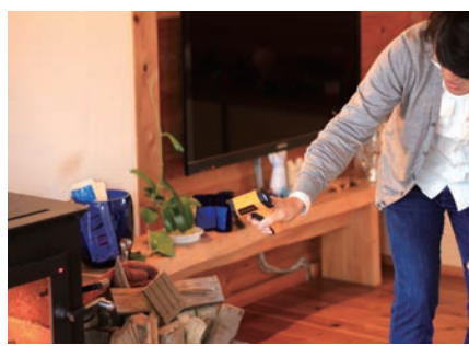
放射温度計で壁等の表面温度を測ることで、体感温度を知ることができます。体感温度はおおよそですが(表面温度+室温)/2と言われています。
