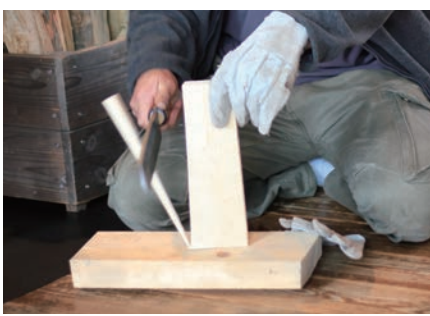
焚き付けに使う薪は鉋を使って割った細いものを使います。木目方向に割ってあげると、簡単に割れます。
