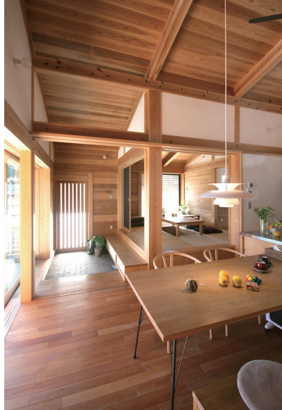
ダイニングキッチンと玄関、和室が一体となった空間。それぞれの空間は障子や襖でつながりを調整でき、来客に合わせてちょうど良い仕切りをつくっている。玄関と和室には60cmの段差を設け、靴収納を兼ねた踏み台を介してつながりをもたせた。和室とダイニングとの段差は、引出し収納となっている。
