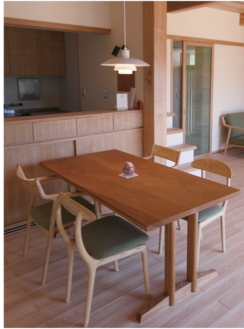
椅子に合せ、ナラ材の天板で建具屋さんにテーブルを製作してもらった。建具の仕組みや技術に応用して作り、主要な接合部は木組みで出来ている。
