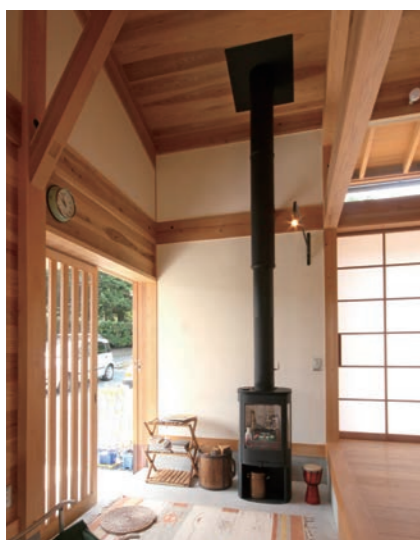
室内側に設けた土間スペースには薪ストーブを設置。土足のまま出入りできるスペースは民家の土間と同じく様々な用途で使えて便利。
