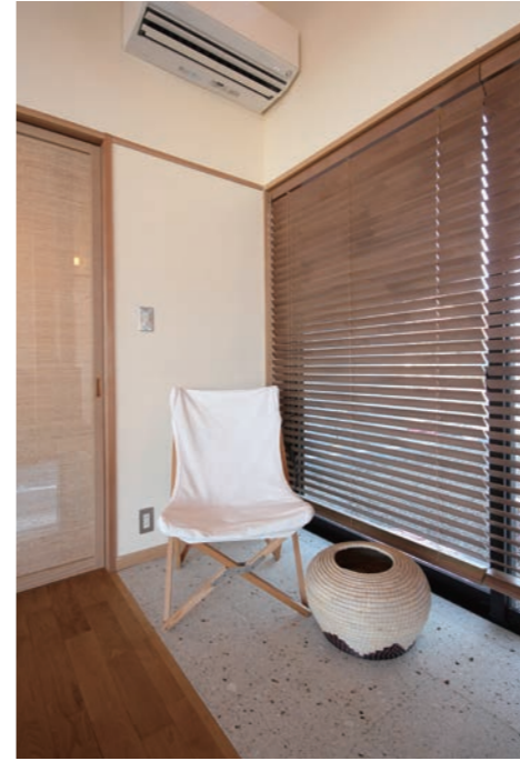
床の仕上げを変える事で、空間に変化が生まれ、心地よい居場所をつくる事が出来た。大谷石は空気をたくさん含んだ石のため、それほど冷たくならず、程良い柔らかさを感じる素材。
