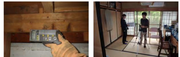
床下木材の含水率を測定。床下の湿度が高いと、シロアリや腐朽菌が好む環境になる。部屋にレベル器を置いて床の不陸を調査。大きな傾きがあれば地盤沈下を疑うこともある。今回は問題なし。
