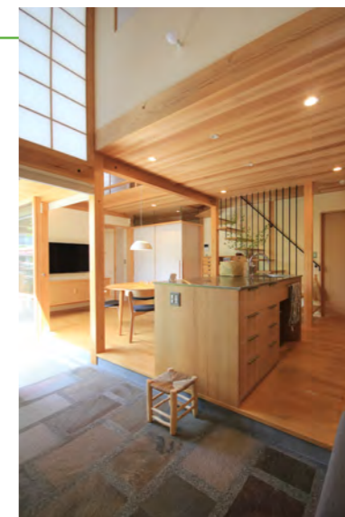
石土間……石土間の部屋から対角線を見る。窓を開けると外部空間も一体となり、より広さを感じられる。石土間は床板より17cm程下げた高さとし、少し落ち着いた空間を意識した。
